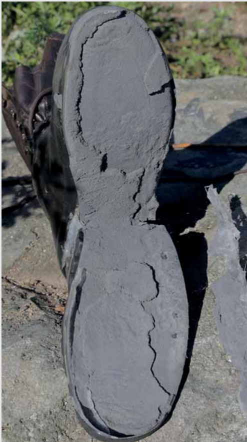
KOKO pohjan etuosa on lähtenyt irti, ja vauriota on yritetty korjata silikonilla.
